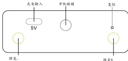
如果点焊机屏幕在60分钟后仍无法点亮，您可以断开连接电线，然后按复位按键，按按键开机。
